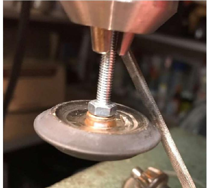
Ci-dessus une réfection du galet au moyen d'une lime et d'une perceuse. On veillera à garder la même forme et ne pas trop diminuer le diamètre du galet. Ceci afin de ne pas affecter son positionnement mécanique sous le plateau. Un diamètre trop petit n'assurera plus la transmission de rotation moteur sur le plateau.
